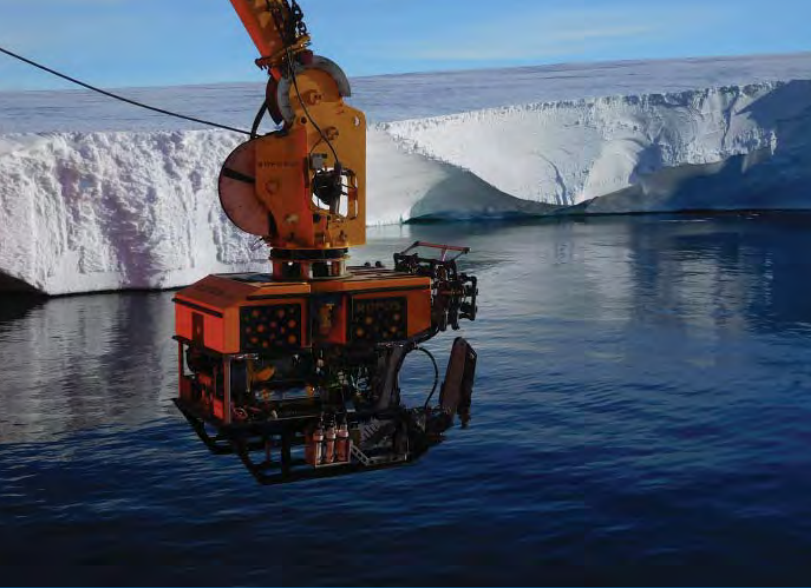
Подводный аппарат "ROPOS" готов к спуску под ледник Мерц
