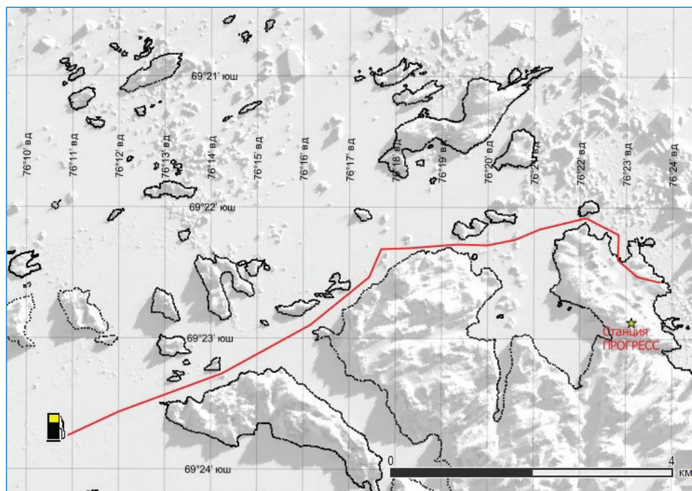
Основной вариант прокладки трубопровода для слива топлива с НЭС «Академик Федоров» на станцию Прогресс в 62-й РАЭ.
