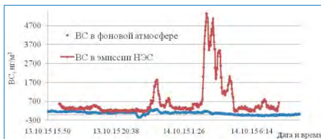
Массовая концентрация BC в фоновой атмосфере Карского моря и локальное загрязнение эмиссией выхлопной трубы судовой силовой установки НЭС.
