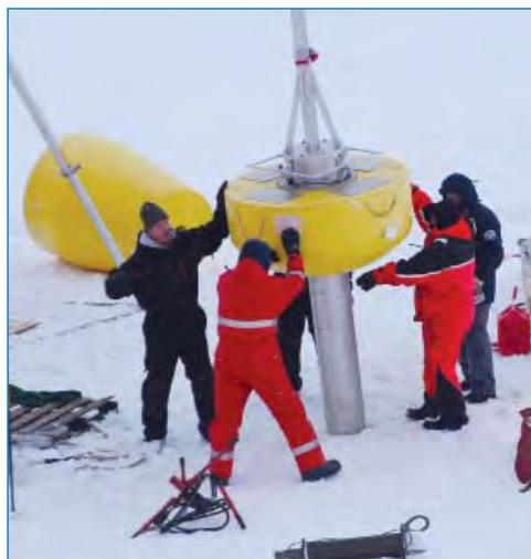
Установка на лед дрейфующих автономных измерительных комплексов.
