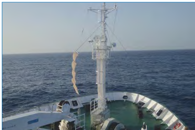
Постановка сетей для сбора аэрозолей (верхний снимок) и вид сетей на баке НИС «Академик Иоффе» в области, находящейся под влиянием потоков из африканских пустынь (нижний снимок). Фото З.Ю. Реджеповой.
