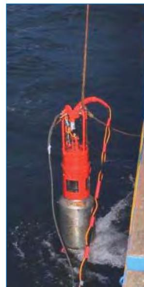
Сброс донной сейсмической станции самовсплывающего типа (слева) и пневмоисточник типа СИН-6М (справа) (разработка ОАО «Севморгео»).
