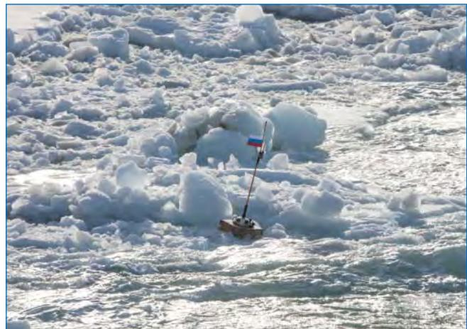
Радиотелеметрический буй с гидрофонами.
