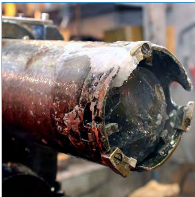
Буровая коронка с зашламованным промывочным окном. Фото В.Я.Липенкова.
