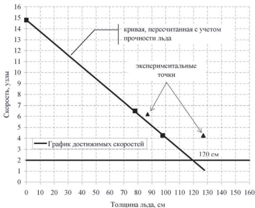
Рис. 5. График достижимых скоростей НЭС «Академик Трешников» при движении носом вперед в сплошном ровном льду.
