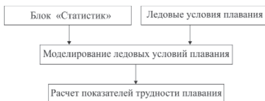
Рис. 1. Схема расчета показателей трудности плавания судов во льдах.
