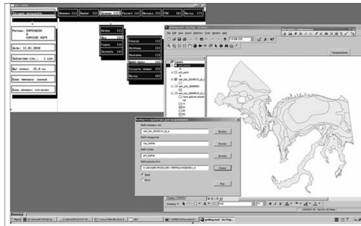
Рис. 1. Интерфейс программы преобразования исходной ледовой карты из формата ГИС ArcView в матричный формат численной модели
