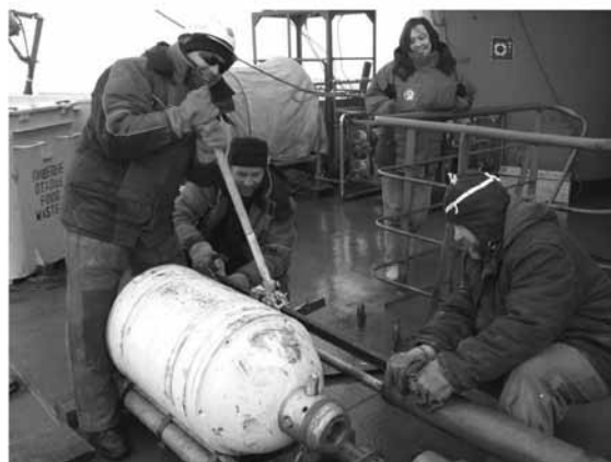
Рис. 6. Работа гидростатической трубкой на вертолетной палубе а/л «Россия» Вверху – подъем трубки. Длина полученного керна – 10,5 м. Внизу – извлечение керна при помощи домкрата
