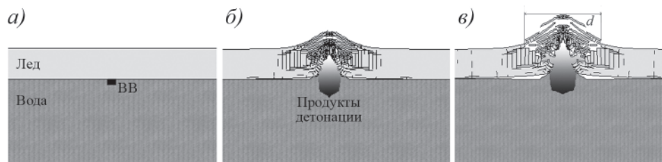
Рис. 4. Численное моделирование подрыва льда, расположенного на водной подложке. Толщина льда 80 см, масса закладки ВВ 4 кг. Размер майны d \sim 210 см.
