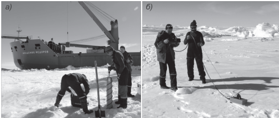
Рис. 2. Выполнение буровых (а) и георадарных (б) работ на морском льду в районе п/б Молодежная. Фото С.С. Пряхина.
