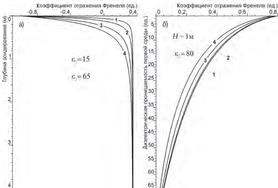
Рис. 4. Зависимость коэффициента отражения Френеля от глубины зондирования (а) и диэлектрической проницаемости сред (б) при двухпозиционных зондированиях.
