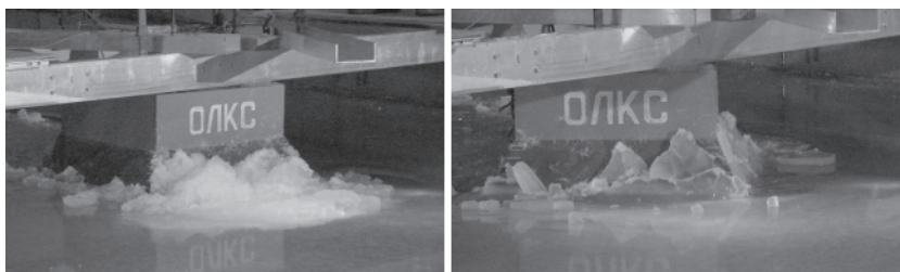
Рис. 7. Модель сооружения гравитационного погружного типа во время испытаний в ледовом бассейне при толщине моделированного льда 23 мм (что соответствует 1,4 м в натуральных условиях): воздействие льда на фронт сооружения (слева) и воздействие льда под углом 45^\circ к фронту сооружения (справа).
