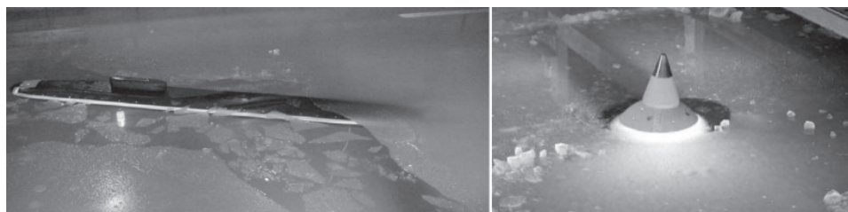
Рис. 9. Всплытие подводной лодки (слева) и спасательной камеры (справа) во время экспериментов в ледовом бассейне ААНИИ.
