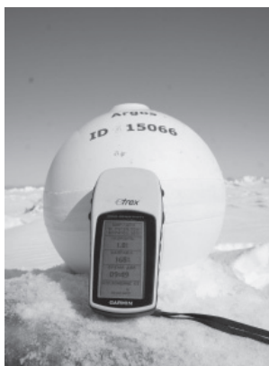
Рис. 4. Радиомаяк спутниковой системы ARGOS, установленный в припае.
